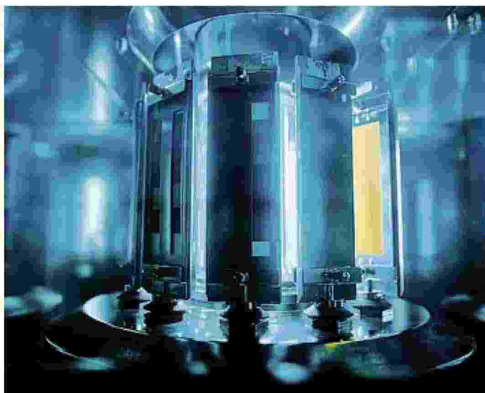
Carvico: test di esposizione del tessuto alla luce nel laboratorio qualità
